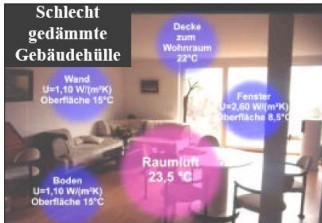
Obr. 10 teploty na povrchu vnějších špatně izolovaný obvodový plášť budovy Schlecht gedämmte Gebäudehülle - na povrchu vnějších špatně izolovaný obvodový plášť budovy; Decke - stropy; Wand - obvodové stěny; Fenster - okna; Raumlüft - vzduch v uzavřeném prostoru
